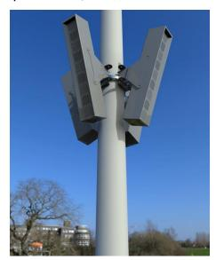
БАО-240.03 модифицируется в **AC-240.03** (акустическую систему Hi-Fi) при исключении интегрированного контроллера управления с усилителем мощности и системы бесперебойного электропитания с АКБ.
