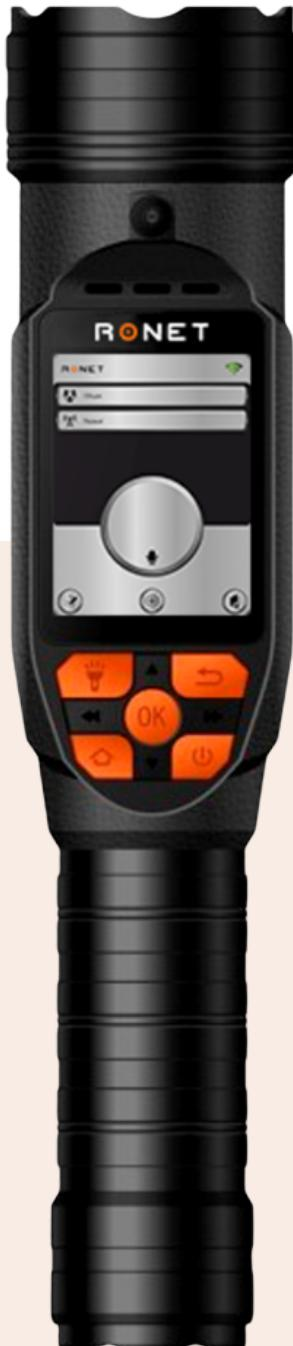
Терминал носимый 3G/LTE, Android, с установленным клиентским программным обеспечением Ronet с функцией подсветки и фото/ видеокамерой, в комплекте со стандартными аксессуарами: LiIon battery, USB cable, Charger, руководство по эксплуатации.
